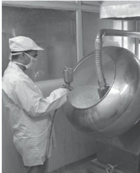
شکل ۴- عملیات روکش دهی قرص‌ها در یک کارخانه دارویی.
