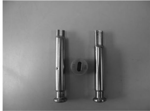
شکل ۱- مثال‌هایی از سنبه و ماتریس مورد استفاده در پرس تک- سنبه قرص. قرص‌های تولید شده با استفاده از این سنبه‌ها به ترتیب (a) گرد و (b) بیضوی می‌باشند.
