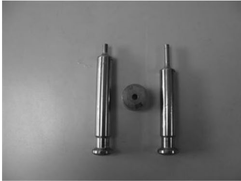
شکل ۱- مثال‌هایی از سنبه و ماتریس مورد استفاده در پرس تک- سنبه قرص. قرص‌های تولید شده با استفاده از این سنبه‌ها به ترتیب (a) گرد و (b) بیضوی می‌باشند.
