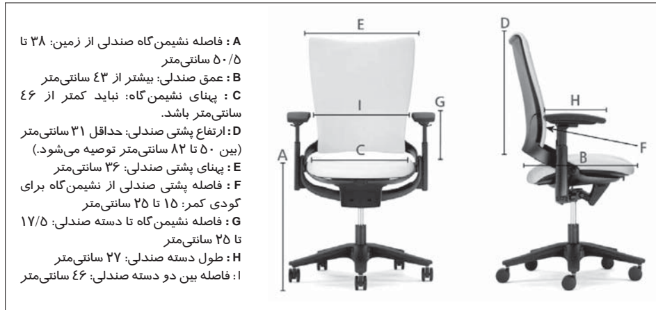
شکل ۴ - صندلی ارگونومیک با اندازه‌های آن
