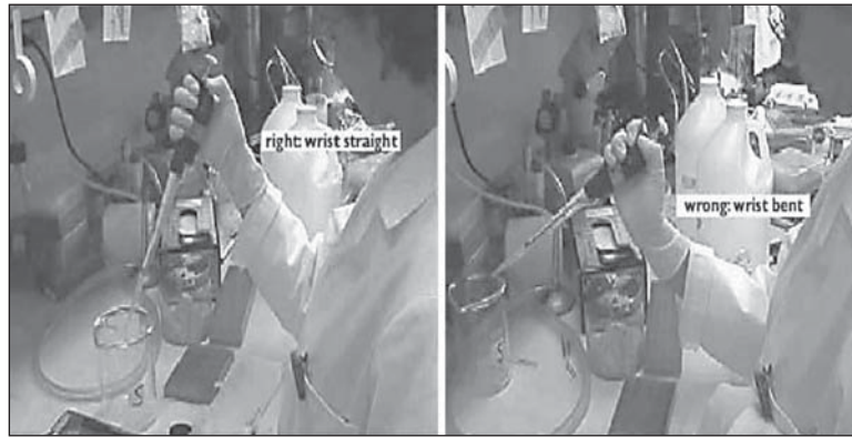
شکل ۱- وضعیت درست و نادرست مچ دست هنگام پی‌پت کردن
